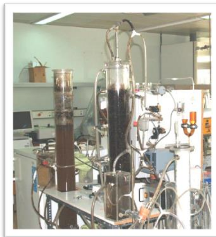
Ερευνητική μονάδα Αναερόβιας Χώνευσης
