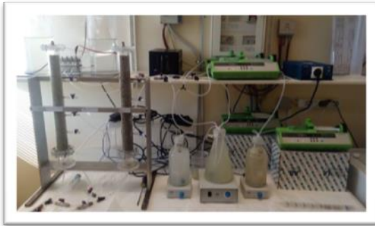
Υδρογονοτροφική απονιτροποίηση πόσιμο νερού
